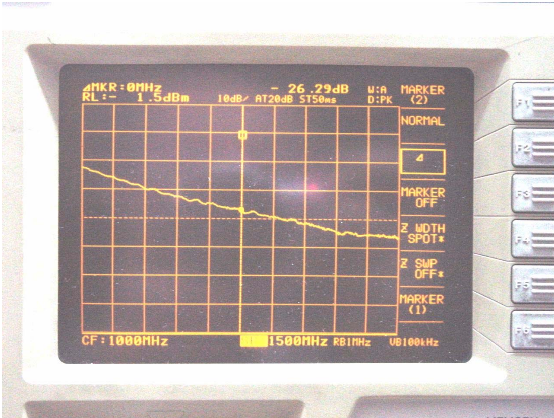
Pérdidas de inserción del Cable AS200-6/50 de 0 a 1,5 GHz. (equivalente a Ø RG-58)
